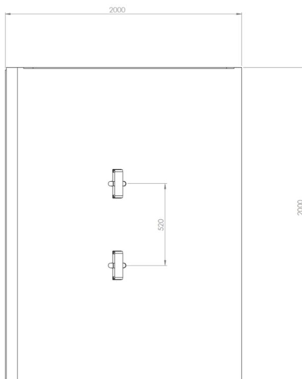
Cette rampe se déplace facilement grâce aux deux fourreaux de fourche disposés sur sa face supérieure à l'aide d'un chariot élévateur.
